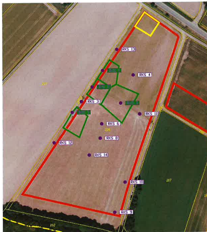
Abb. 6: Luftbild mit Eintragung der Altlastenflächen (grün) und dem Batteriespeicher (gelb) innerhalb des Solarfelds 6
